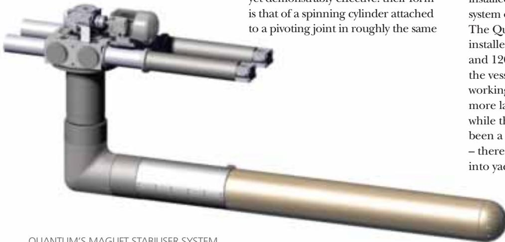
QUANTUM’S MAGLIFT STABILISER SYSTEM, SUITABLE FOR THE LARGEST VESSELS.
